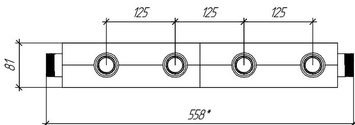
\* Используется для разметки отверстий кронштейнов (см. инструкцию K.UMS)
